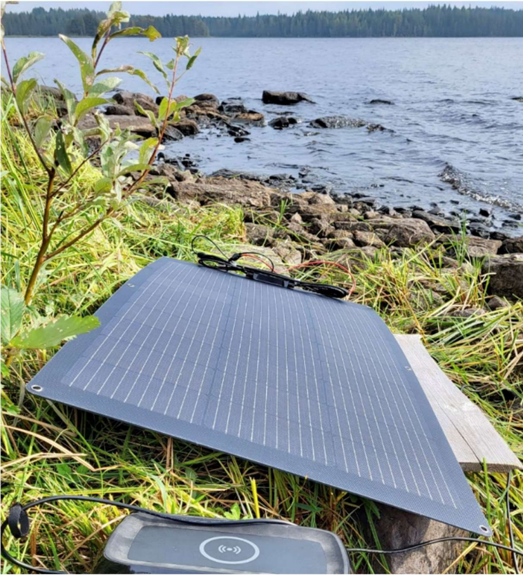
Kuva 7. Ecofow 100 W ohutkalvopaneeli lataamassa virta-asemaa saarella. [Arffman2023].
