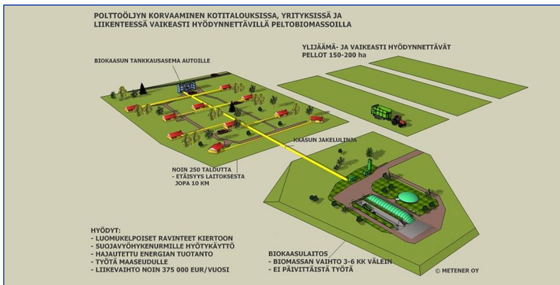
Kuva 11. Metener Oy:n visio peltobiomassojen hyödyntämiseksi biokaasutuotannossa [10]
