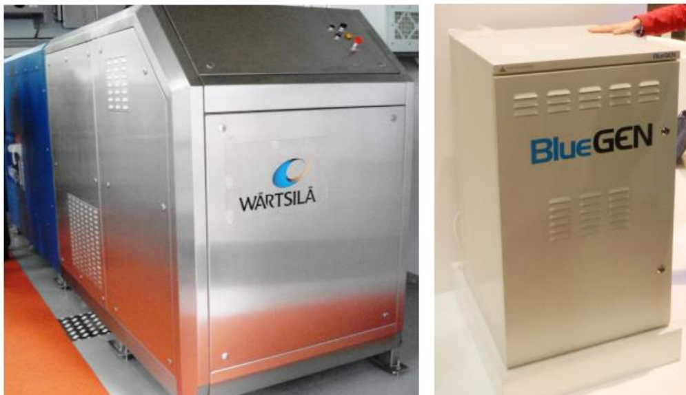
Kuva 37 SOFC-polttockennoja: a) Wärtsilän 20 kWe:n polttokennojärjestelmä kaatopaikkakaasukäytössä Vaasassa. b) 1 kWe:n polttokenno \mu CHP-järjestelmiä varten esittelyssä Berliinissä. Kuvat. Ari Lampinen [9]
