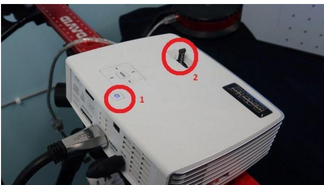
Projektorin 1) virtakytkin ja 2) tarkennus
