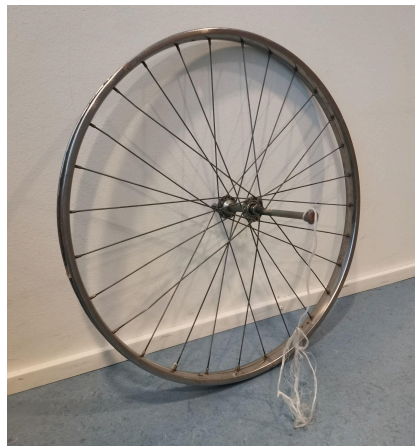
Kuva 2: Työssä käytetty gyroskoopin prototyyppi, joka on rakennettu pyöränvanteesta, akselista ja narusta.
