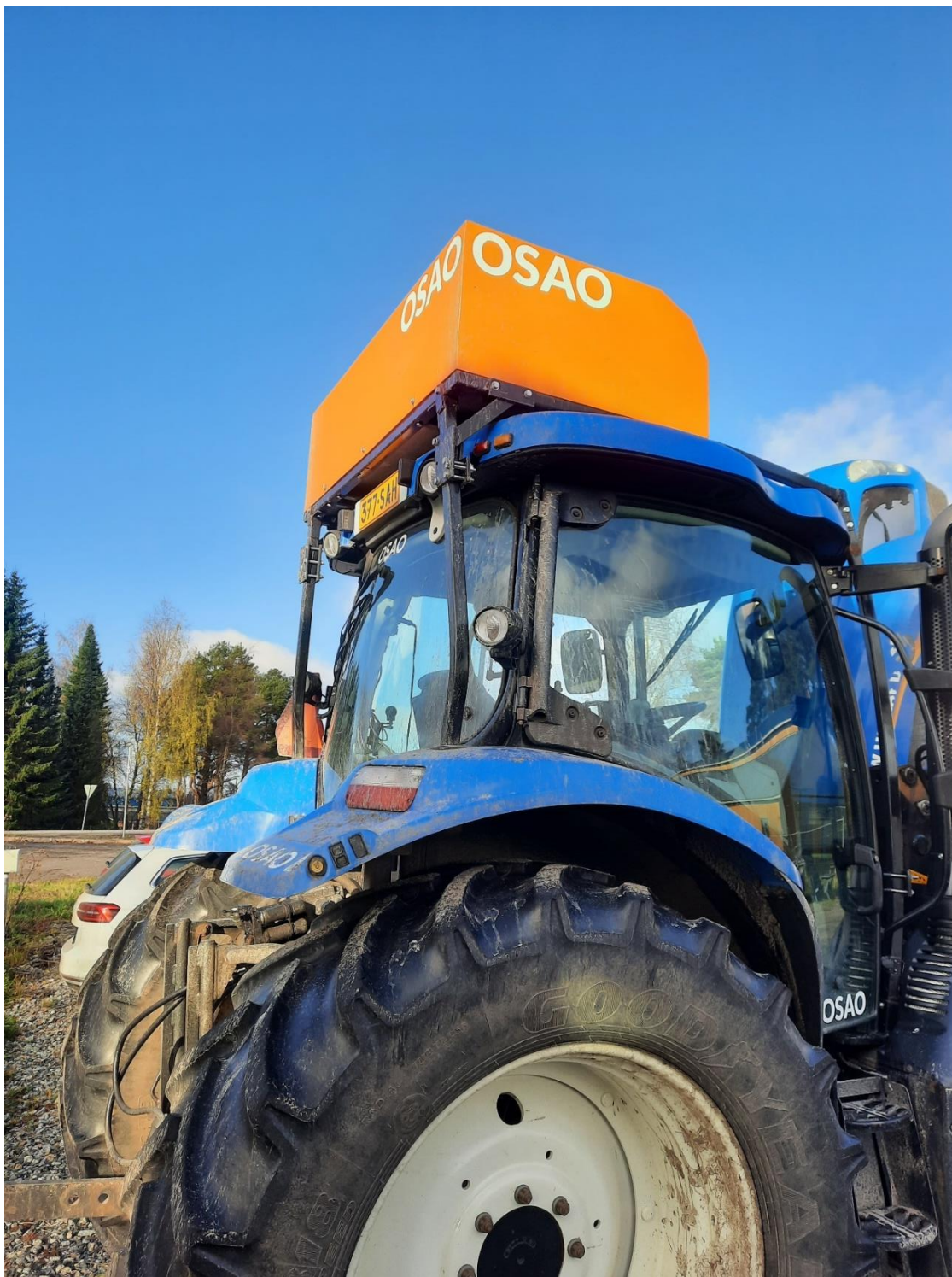
Kuva 1. Kaasusäiliöille on rakennettu oma paikka ohjaamon päälle. Koska ohjaamoon ei saanut kiinnittää mitään, piti tarkoitusta varten rakentaa erillinen kehikko ohjaamon ympärille. Kuva: Mikko Aalto.
