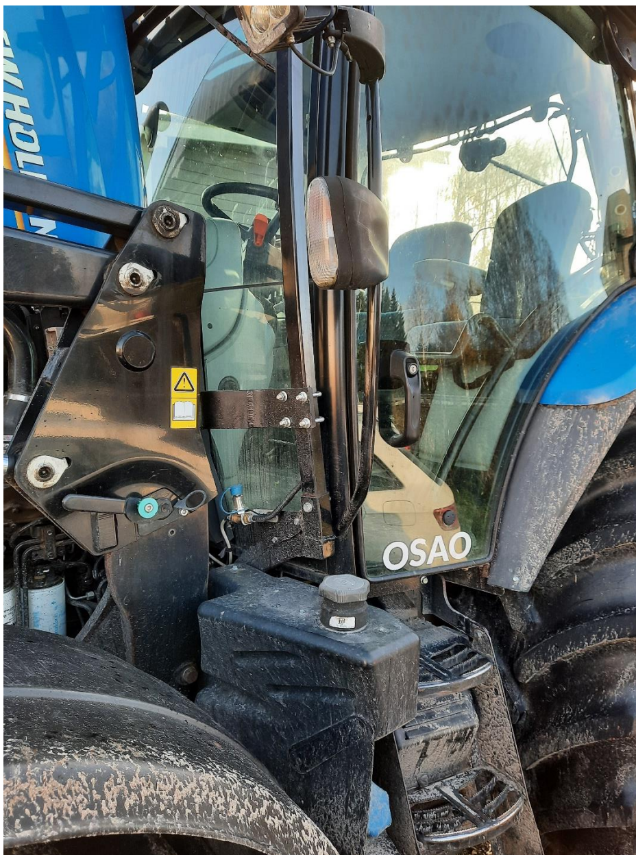
Kuva 3. DualFuel -järjestelmä käyttää yhtä aikaa sekä dieseliä että kaasua (CBG tai CNG). Kuvassa ohjaamon etulasin alaosan edessä näkyvä sininen korkki peittää kaasujärjestelmän tankkausyhdetä ja harmaa korkki on dieseltankin korkki. Kuva: Mikko Aalto
