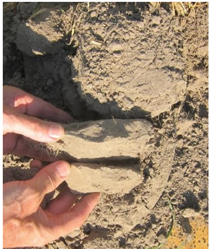
Kuva 6. Liuskeinen rakenne paljastaa hienohietamaan tiivistyneen voimakkaasti.
