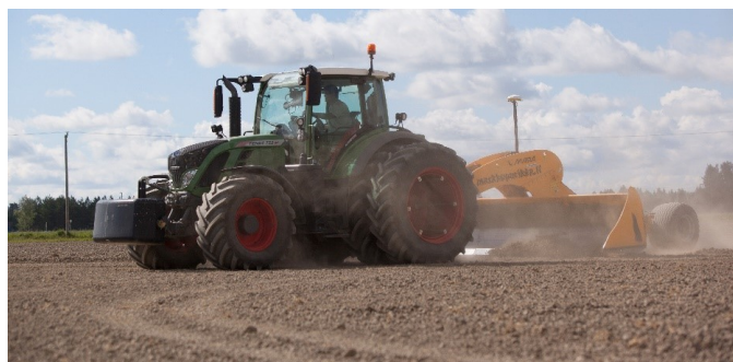
Bild 5. Med en automatisk planeringsladd kan man forma åkerns yta så att ytavrinningen blir hanterbar. Bild: Ville Virtanen.
