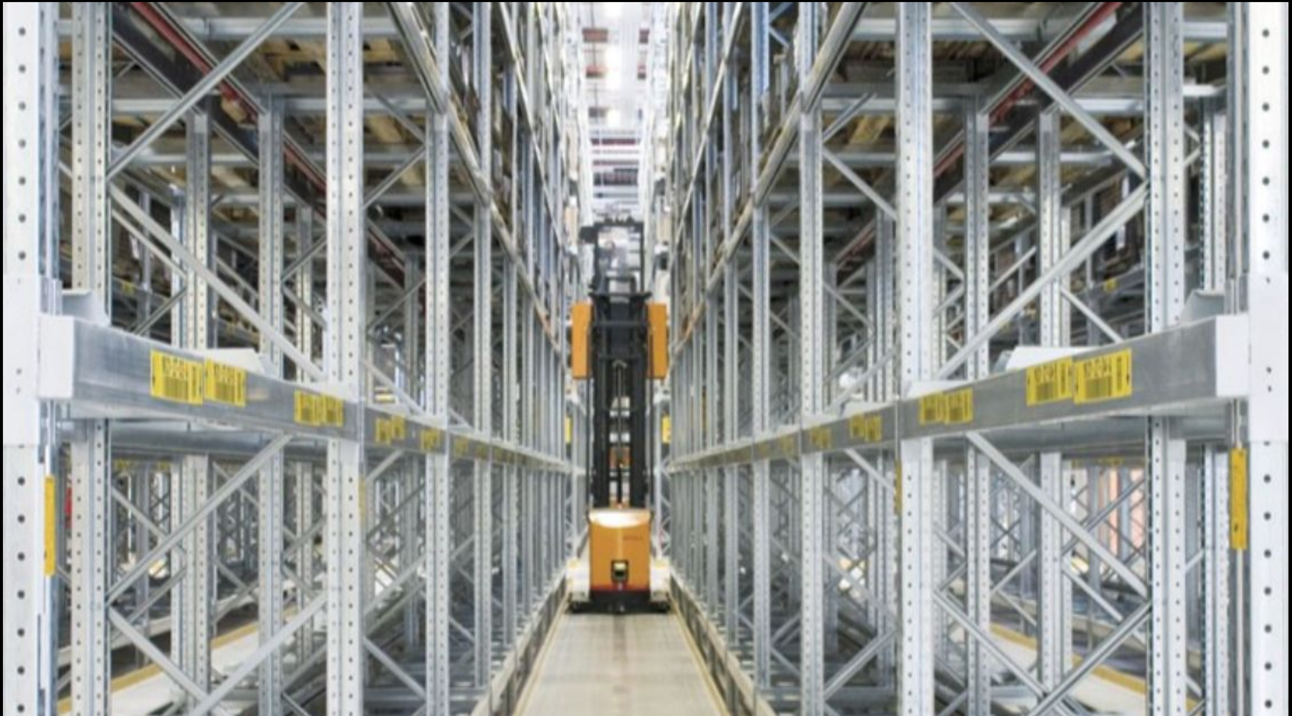
Вузькопрохідні склади (Narrow aisle warehouse, Photo: Dexion)
