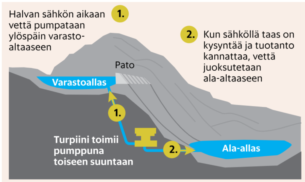
Kuva 9 Pumppuvoimalan toimintaperiaate [Lassila 2023].
