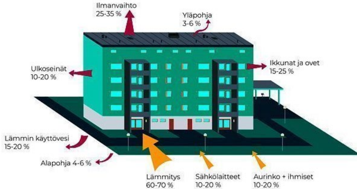
Kuva 1. Lämpöenergiatase 1960-1980 -lukujen asuinkerrostaloissa (lähde: Taloyhtiön energiakirja)
