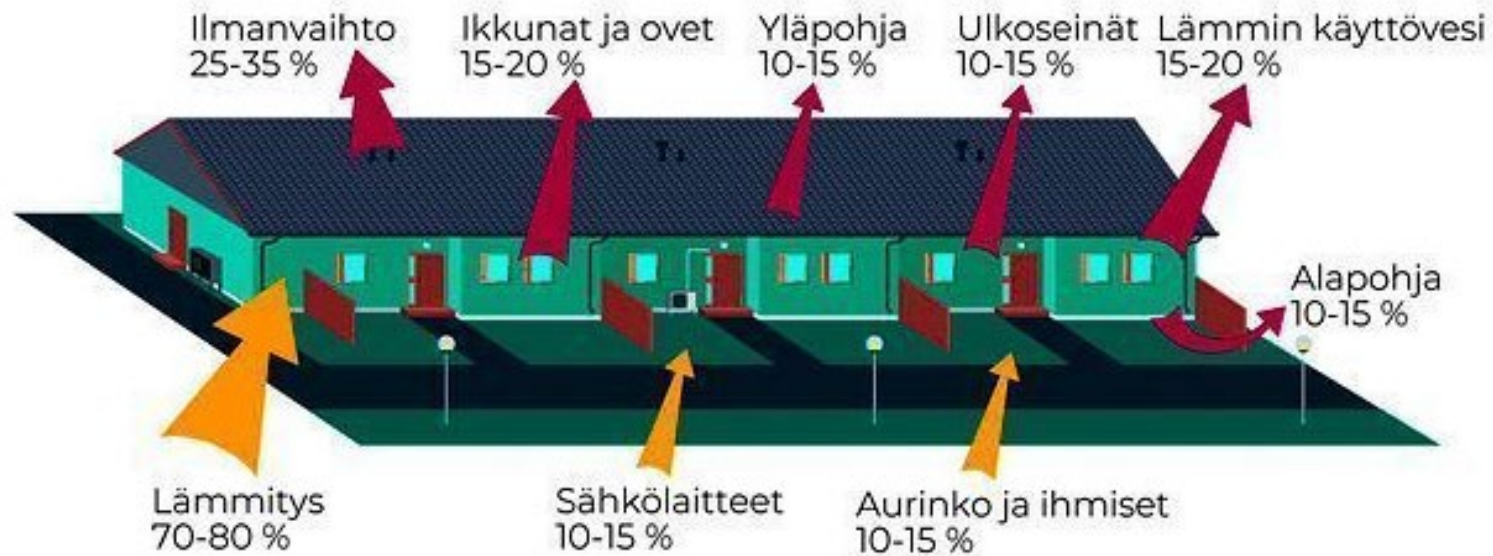
Kuva 2. Lämpöenergiatase 1970-1990 -lukujen rivitaloissa (lähde: Taloyhtiön energiakirja)
