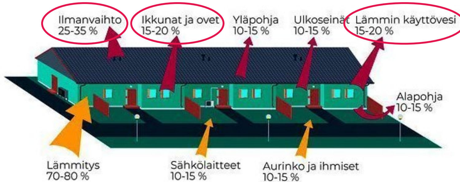
Kuva 2. Lämpöenergiatase 1970-1990 -lukujen rivitaloissa (lähde: Taloyhtiön energiakirja)
