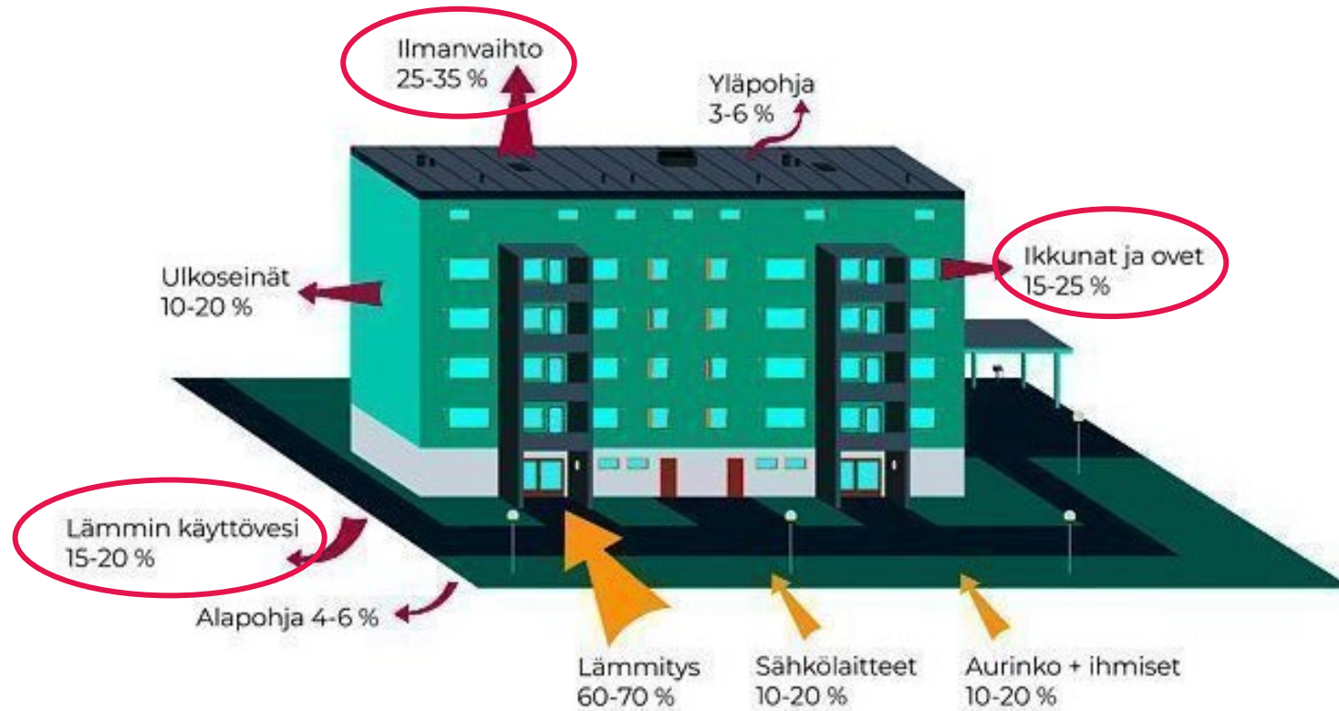
Kuva 1. Lämpöenergiatase 1960-1980 -lukujen asuinkerrostaloissa (lähde: Taloyhtiön energiakirja)
