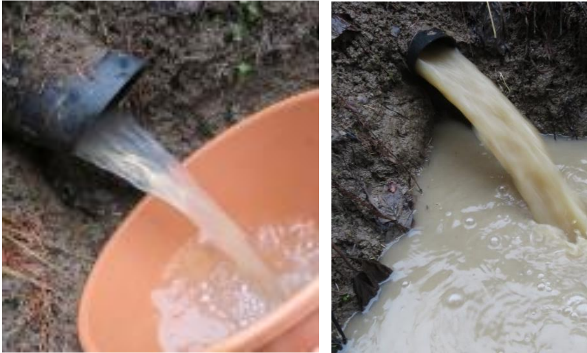
Kuva 4. Laskuaukosta mitatun virtaaman tulisi normaalisti mitoitetuissa salaojastoissa olla märkään aikaan 1 l/s/ha, joka vastaa 8,6 mm/vrk salaojavaluntaa. Vasemman-puoleisessa kuvassa virtaama on 0,2 ja oikean puoleissa 0,9 l/s/ha. Kuvat: Jukka Rajala
