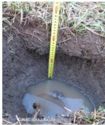
Kuva 2. Pohjaveden korkeutta voidaan selvittää lapiokuoppamenetelmällä märkään aikaan. Kuvat: Jukka Rajala
