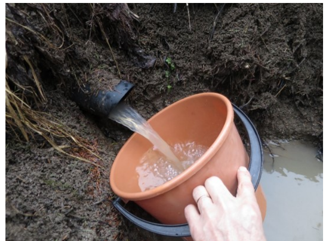
Kuva 4: Salaojaston toimivuutta voidaan selvittää mittaamalla laskuaukosta tuleva vesimäärä. Kuva Jukka Rajala.
