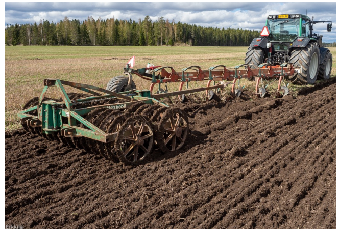
Kuva 10. Kevyen maan matalahkoa kyntöä keväällä sängeltä alhaisin rengaspainein. Hinattava pakkeri tiivistää ja tasaa kynnöksen kylvövalmiiksi. Kuva: Timo Erkkilä.
