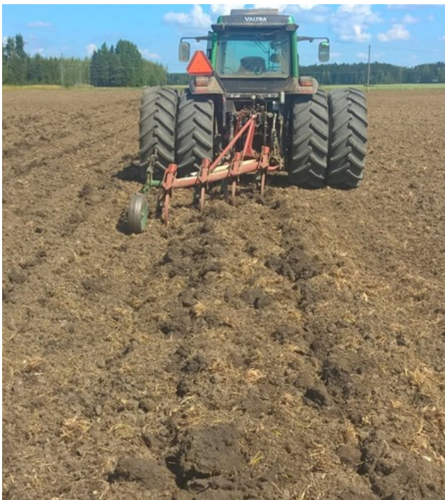
Kuva 9: Sängeltä kyntöä /kuohkeutusta voidaan tehdä irrottamalla siivet kyntöaurasta. Kyntö onnistuu hyvin myös paripyörillä. Kynnetty kaista on normaalista poiketen traktorin vasemmalla puolella. Siivettömällä auralla tiivis maa saadaan kuohkeutettua noin 25 cm syvyyteen. Kuva: Jukka Rajala.
