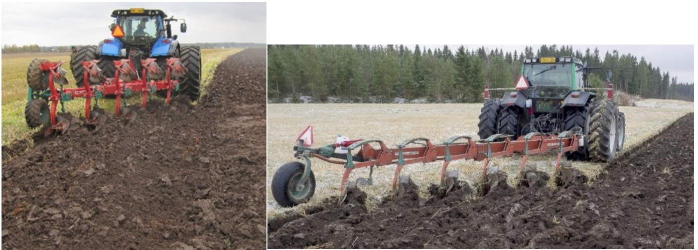
Kuva 5. Sängeltäkyntöauroja tehdasvalmisteisena vasemmalla ja viljelijän itsensä muuntamana oikealla. Paripyörillä sängeltäkyntö onnistuu näillä hyvin edellyttäen, että paripyörien välit eivät täyty maalla. Kuvat: Jukka Rajala ja Timo Erkkilä).
