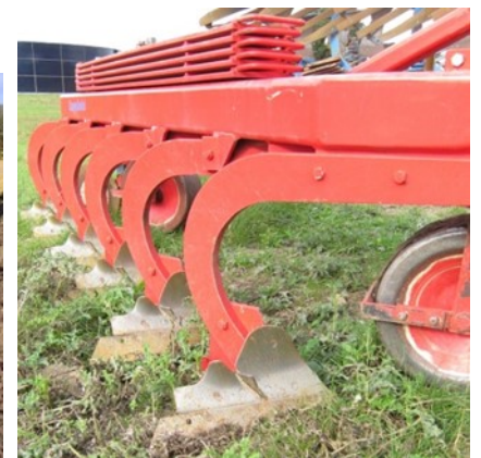
Kuva 8. Kolme matalakyntöauraa: Kverneland Ecomat, A-Faber minisiipiaura, saksalainen Stoppelhobel sänkihöylä. (Kuvat: Kverneland, A-Faber ja Jukka Rajala).
