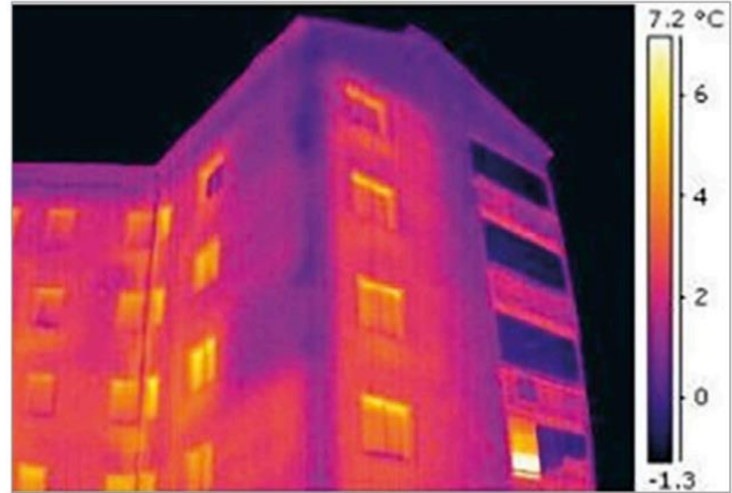
Kuva 3.12. Viistosateen aiheuttamaa lämpötila- ja kosteusvaihtelua rakennuksen julkisivulla. Lämpökuvissa näkyy havainnollisesti kuinka nurkka-alueet ja päädyt ovat muuta julkisivua kylmempiä alueita. Lisäksi yhden asunnon kohdalla on tehty lisälämmöneristys sisäpuolelta. Seinä ei kuivu enää yhtä nopeasti kuin eristämätön seinä. Kuvat: P. Räisänen, Vahanen Oy.
