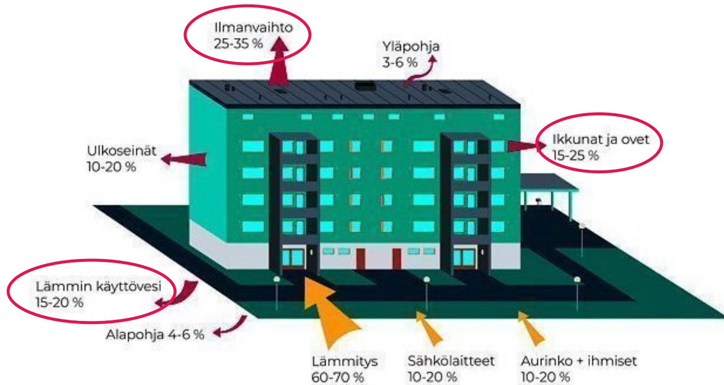
Kuva 1. Lämpöenergiatase 1960-1980 -lukujen asuinkerrostaloissa (lähde: Taloyhtiön energiakirja)
