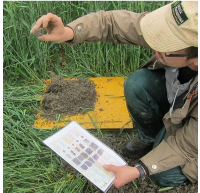
Kuva 1: MARA-tarkastelulla maan rakenteesta saadaan hyvä kuva. Kuva Jaana Ravander.
