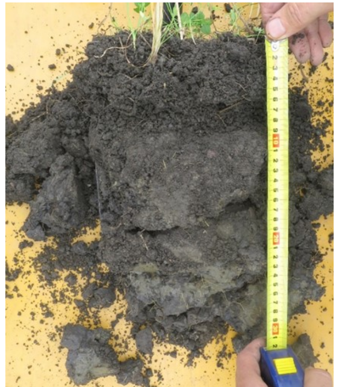
Kuva 3: Käsittele ja murra varovasti näytettä esimerkiksi vanerilevyn päällä. Näytteestä erottuu useimmiten kerroksia. Mittaa kerrosten paksuudet ja määritä jokaisen kerroksen maan rakenne viisi-portaisella asteikolla MARA-kortin ohjeiden avulla. Kuva Jukka Rajala.
