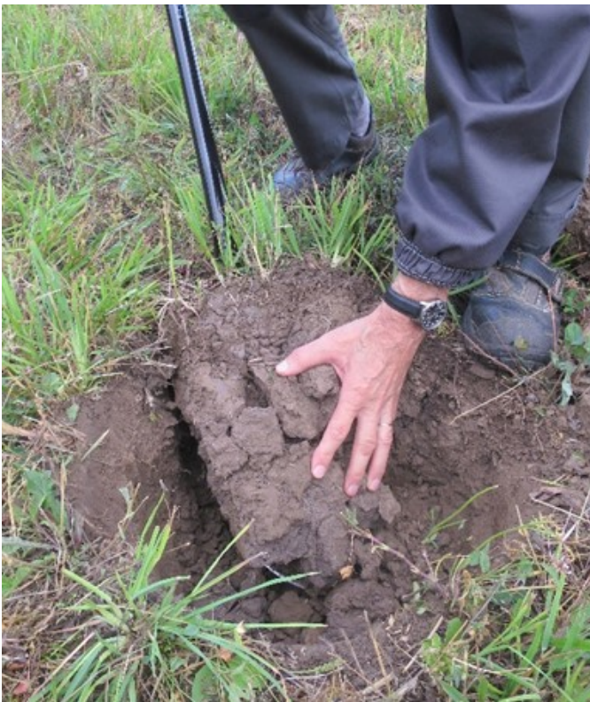
Kuva 2: Aistinvaraista maan rakenteen määrittämistä varten lapiolla kaivetun kuopan reunasta leikataan vähintään ruokamultakerroksen syvyydeltä näyte. Kuva Jukka Rajala.
