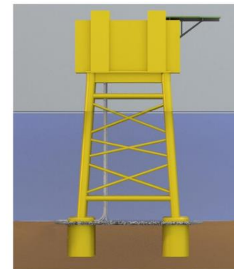
merisähköaseman ristikkorakenteinen perustus
