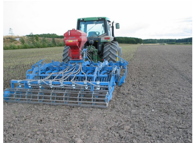
Kuva 2. Raskaissa lautasmuokkaimissa on suuret halkaisijaltaan yli 50 cm hammastetut kiekot, jotka läpäisevät ja pilkkovat runsaasti kasvitähdettä. Lautasten takana olevat harat tehostavat kasvitähteen sekoittumista ja multaantumista, mikä on eduksi kylvöä edeltävässä muokkauksessa. Kevytrakenteinen varpa- ja putkijäräpakkeri murskaa kokkareita ja tiivistää maata suuren kosketusalan johdosta vain pinnasta. Kuva: Juuso Joona.
