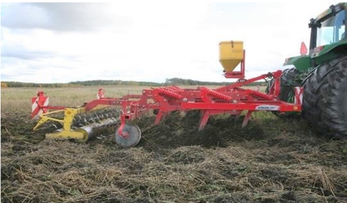
Kuva 4. Kolmiakselinen siipiteräkultivaattori 35 cm leveillä 6–8 cm limittäin menevillä hanhenajaloin varustettuna läpileikkaa muokauspohjan ja sekoittaa maata tehokkaasti, mikäli hanhenjalan keskiosa on nostava. Piikkijyräpakkeri nostaa kasvitähdettä ja juuria pintaan jättäen maan kuohkeaksi. Koneen päälle asennetulla kylvökoneella voidaan kylvää kerääjäkasvusto. Kuva: Juuso Joonas.
