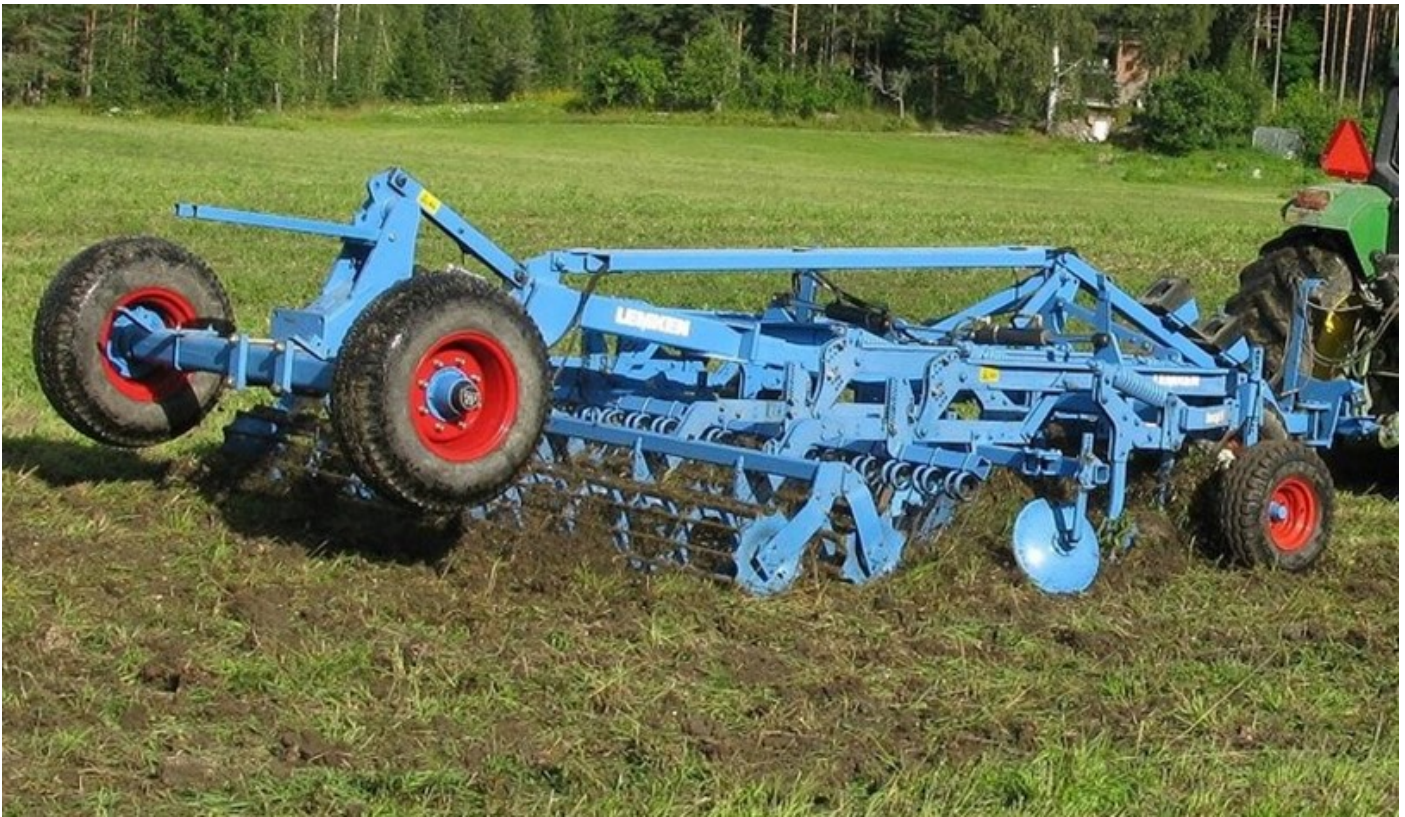
Kuva 5. Hinattavat muokkaimet vähentävät kuormitusta traktorin taka-akselille mahdollistaen alemmat rengaspaineet, mutta ovat usein rakenteeltaan pitkiä, mikä vähentää yhdistelmän kykyä seurata pellon pinnanmuotoja Kuva: Juuso Joo- na.
