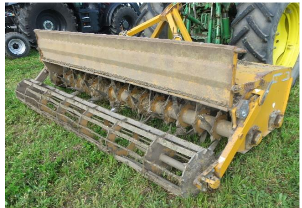
Kuva 2. Vetokelajyrsim muokkaa maan pintakerroksen hellävaraisesti. Kuva: Jukka Rajala.
