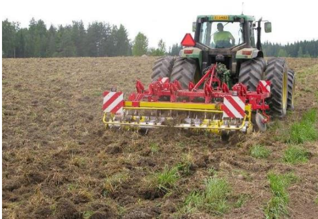
Kuva 1. Kolmiakselinen jäykkäteräinen kultivaattori varustettuna piikkijyräpakkerialla on tehokas väline nurmen lopettamiseen. Kuvassa meneillään toinen ajokerta. Kuva: Juuso Joona.
