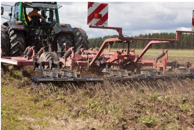
Kuva 3. Neliakselinen jäykkäpiikkinen kultivaattori varustettuna leveillä hanhenjaloilla pikavaihtokärjin ja kolmiosaisella järeäpiikkisellä jälkiharalla sopii hyvin raskaiden maiden muokkaukseen. Työsyvyuden säätö tapahtuu järein kuljetuspyörin. Kuva: Ville Virtanen.
