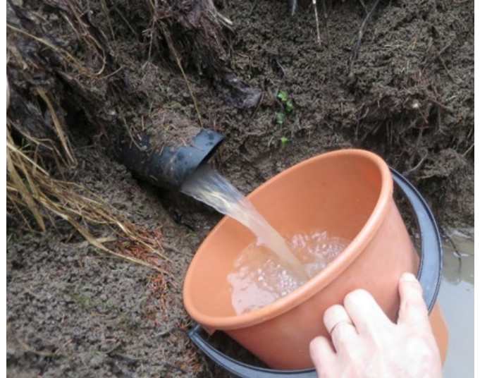
Kuva 2. Virtaamaan voi mitata ämpärillä ja sekuntikellolla, kunhan on huolehdittu siitä, että laskuaukko on kunnollinen ja valtaoja perattu. Kuva: Jukka Rajala
