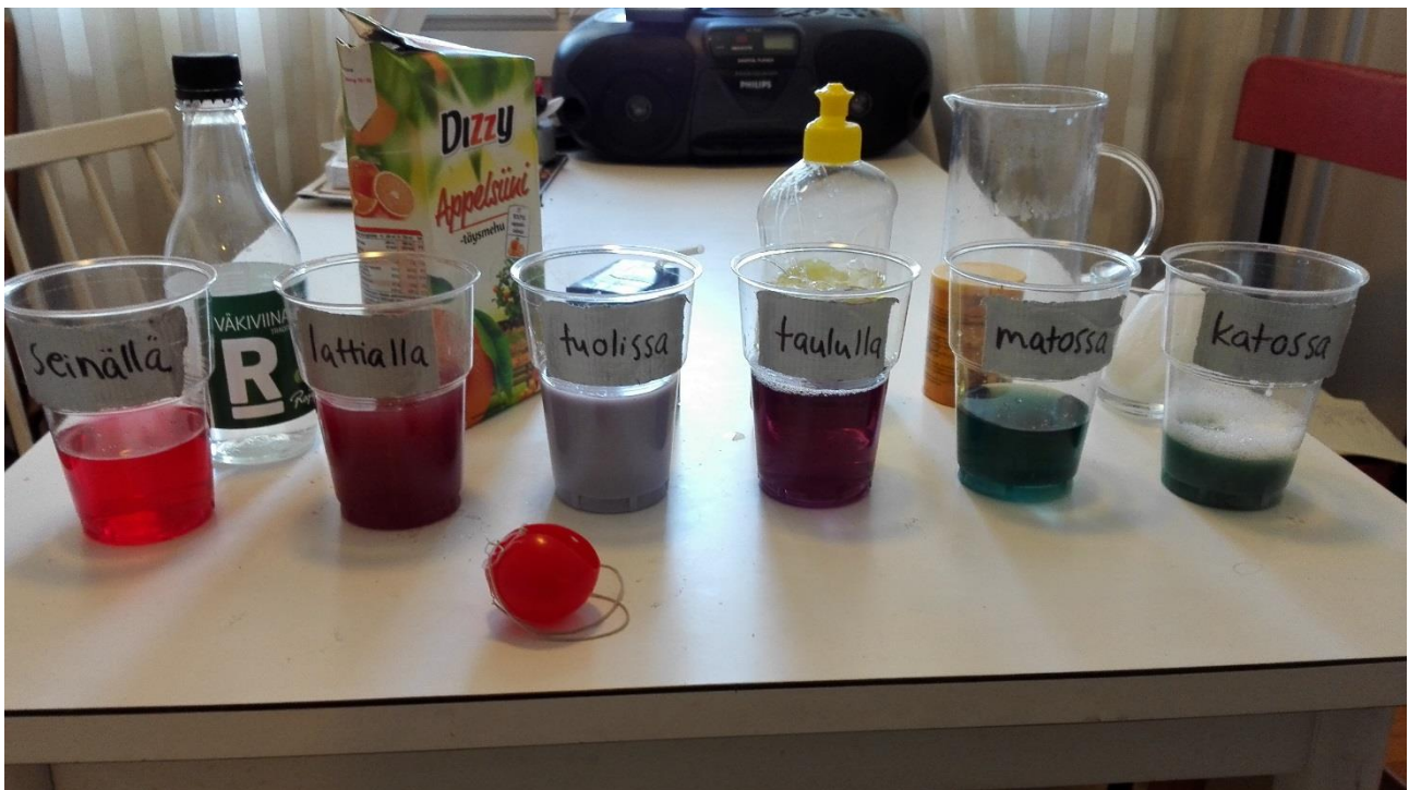
Kuva 3. Eri happamuuksiset nesteet pH-järjestyksessä, kun kuppeihin on kaadettu punakaalimehua
