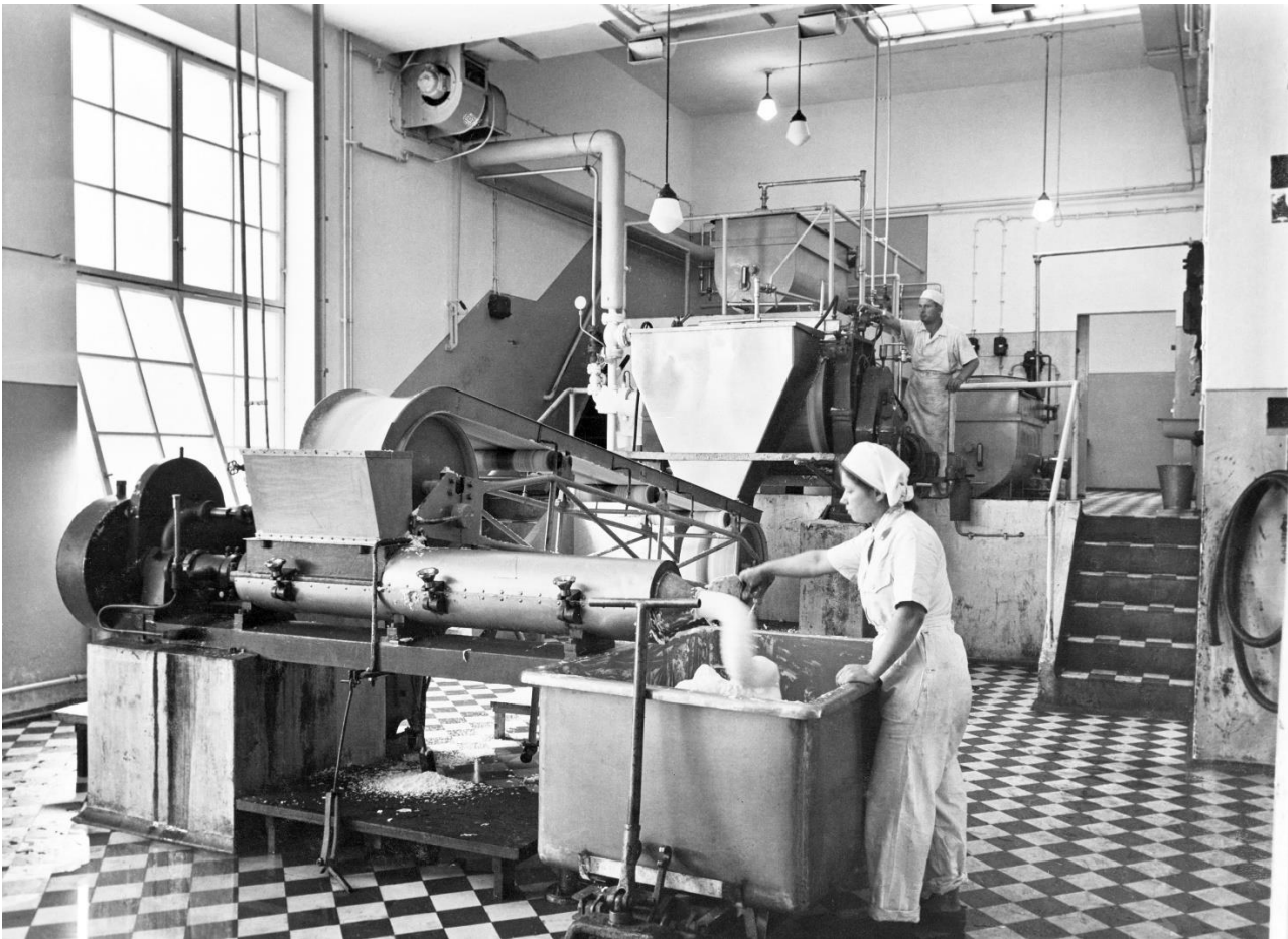
Kuva 16 Margariinin vaivausta Tukon margariinitehtaalla. Kuvaaja tuntematon, Helsingin kaupunginmuseo 1949. Kuvan käyttöoikeus CC BY 4.0. Finna.fi: Linkki kuvan sivulle.
