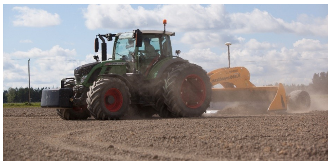
Kuva 5. Automaattisella tasalanalla voidaan muotoilla pellon pinta pintavesien hallinnan kannalta sopivaksi. Kuva: Ville Virtanen.
