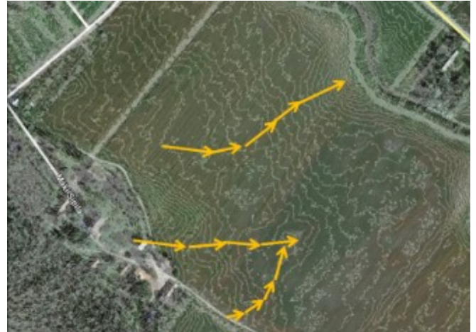
Kuva 1. Vesi virtaa pellolla kohtisuoraan korkeuskäyriin nähden, mikä keskittää vettä painanteisiin ja notkoihin. Laserkeilausaineisto 10 cm korkeuskäyrillä OS-MO-hankkeen tilatutkimuksen Ju-koelohkoilta. Ilmakuva: Google Earth. Piirros ja korkeuskäyrät: Tuomas Mattila.
