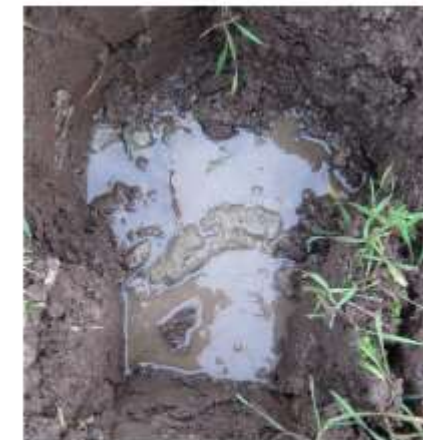
Kuva 1. Pohjaveden korkeus kertoo kuivatustarpeesta ja maan läpäisevyydestä. Kuva Jukka Rajala
