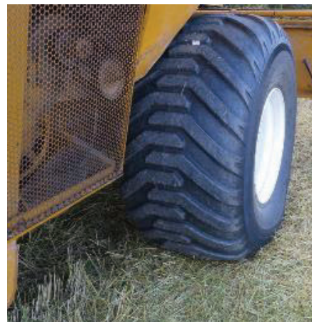
Kuva 4. Tällä renkaalla voidaan puida 0,5 bar paineella kuvan puihurilla, jolloin tiivistymisriski on vähäinen. Kuva Jukka Rajala.
