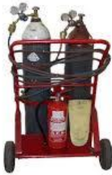
KAASUHITSAUSLAITE (KIVEN POLTTAMINEN)
