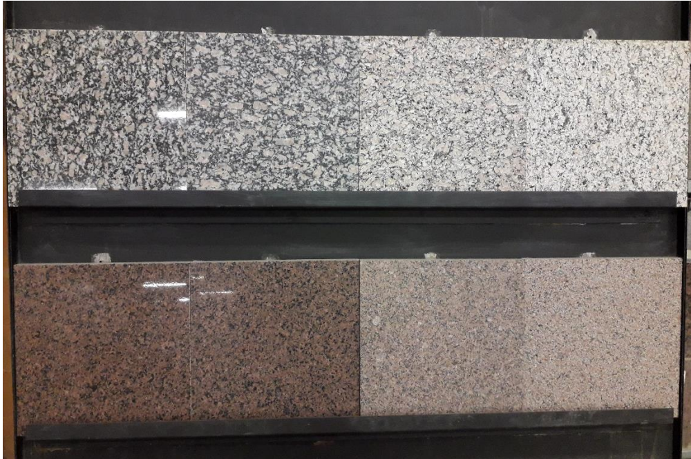
Kiillotettu, mattahiottu, poltettu, ristipäähakattu (kivilaatta)
