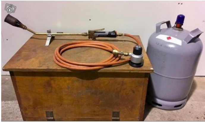
TOHO, NESTEKAASUPOLTIN (LÄMMITYS/SULATUS, BITUMILIIMAUS)
