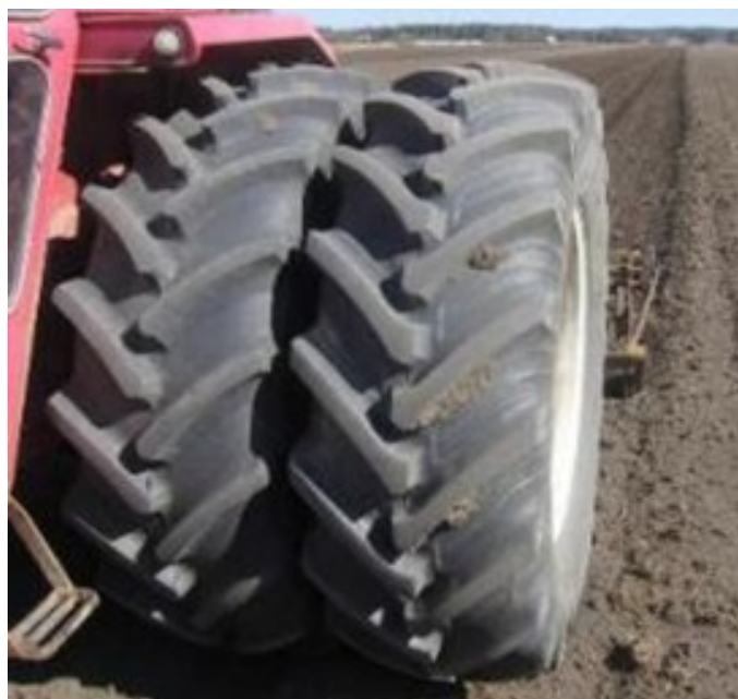
Kuva 1. Paripyöriä käytettäessä rengaskuorma lähes puollittuu ja voidaan käyttää huomattavasti alempia rengaspaineita. Kuvan renkailla äestetään 0,4 bar paineella. Kuva Jukka Rajala.
