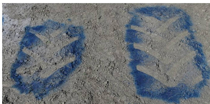
Kuva 2. Rengastyyppi ja rengaspaine vaikuttavat paljon renkaan kosketusalaan. Tiepaine vasemmalla ja peltopaine oikealla. Kuva Jukka Rajala
