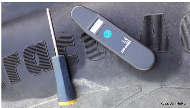
Kuva 8. Tarkka painemittari ja venttiilityökalu ovat tarpeen alhaisia rengaspaineita käytettäessä. Kuva Jari Huikuri.
