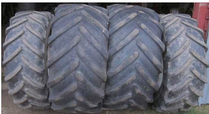
Kuva 7. Renkaiden vaihtaminen suuremmiksi mahdollistaa alempien rengaspaineiden käyttämisen ja vähentää maan tiivistymisriskiä. Kuva Jukka Rajala.
