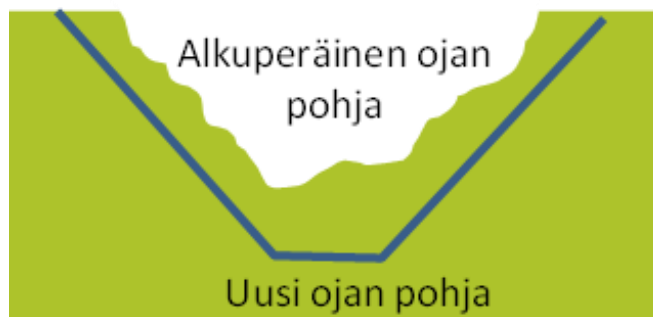
Kuva 5. Ojan syvennys tuottaa runsaasti maamassoja. Maata tulee sitä enemmän, mitä syvemmälle kaivetaan ja mitä loivemmat luiskat tarvitaan.
