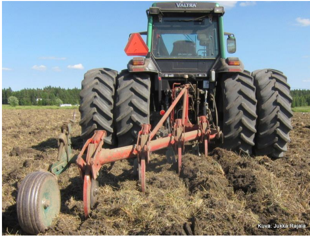
Kuva 10. Maan kuohkeutusta siivettömällä kyntöauralla noin 25 cm syvyyteen. Aurasta on siivet ruuvattu irti ja aura säädetty kulkemaan vasemman pyörän raiteissa.
