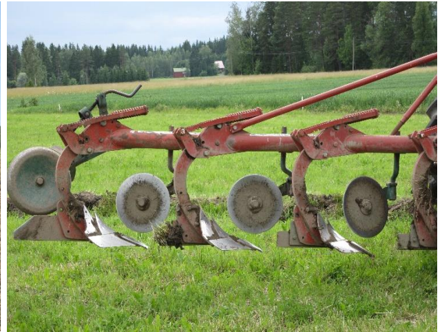
Kuva 10. Maan kuohkeutusta siivettömällä kyntöauralla noin 25 cm syvyyteen. Aurasta on siivet ruuvattu irti ja aura säädetty kulkemaan vasemman pyörän raiteissa.
