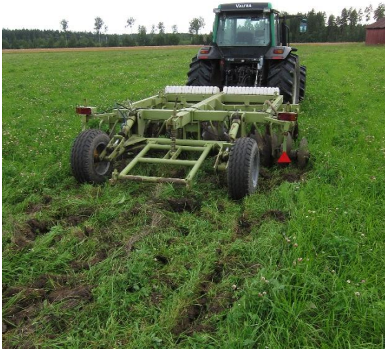
Kuva 6. Kaksivuotisen viherlannoitusnurmen rikkominen aloitetaan ajamalla raskaalla lautasaekellä maan pinta rikki. Vasemmanpuoleisessa kuvassa ajetaan etupainot äkeen päällä ilman jälkiäestä. Oikeanpuoleisessa kuvassa ajetaan ilman etupainoja jälkiäkeen kanssa.
