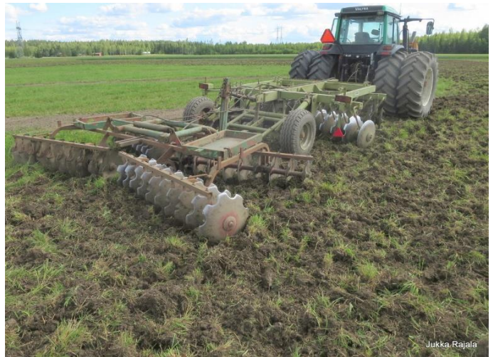
Kuva 6. Kaksivuotisen viherlannoitusnurmen rikkominen aloitetaan ajamalla raskaalla lautasaekellä maan pinta rikki. Vasemmanpuoleisessa kuvassa ajetaan etupainot äkeen päällä ilman jälkiäestä. Oikeanpuoleisessa kuvassa ajetaan ilman etupainoja jälkiäkeen kanssa.
