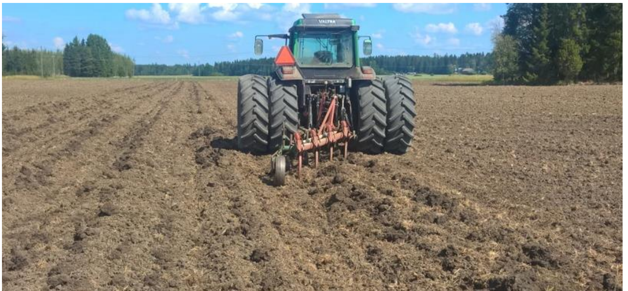
Kuva 11. Ajo siivettömällä kyntöauralla tapahtuu kokonaan sängellä ajaen, kun aura on säädetty kulkemaan vasemmalla vasemman pyörän kohdalla. Paripyöriä voidaan käyttää pinnallaan rikotulla maalla.
